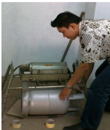
写真2 : 放射線透過試験のため小型圧力容器をセット中
