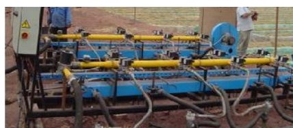
焼成炉上天然ガスバーナー (改善後)
