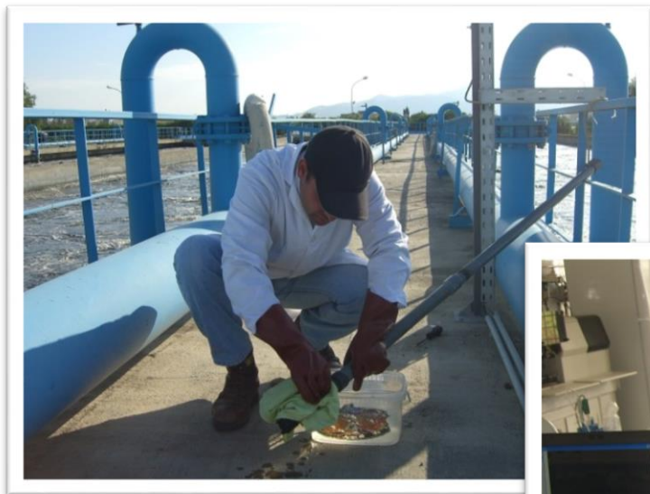
測定器（酸素計）のメンテナンス
