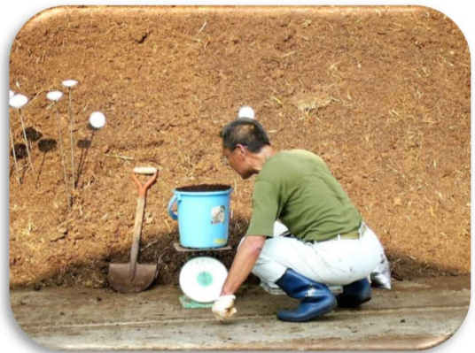
写真 5-3 比重測定による空隙率の管理
